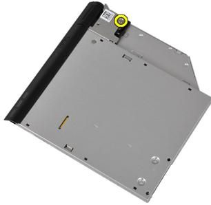
6. Entfernen Sie die Laufwerksverriegelung vom optischen Laufwerk.
