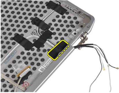
6. Entfernen Sie die Antennenkabel aus der Öffnung in der rechten Bildschirmscharnierplatte.
