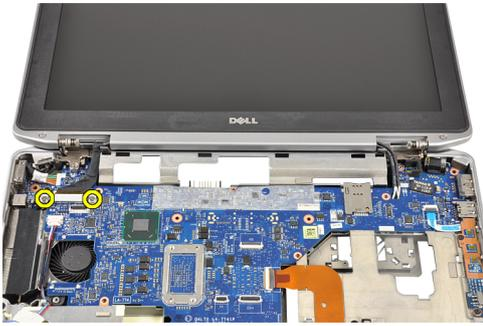
7. Heben Sie den LVDS-Haltebügel an und entfernen Sie ihn.
