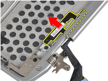
5. Trennen Sie das LED-Platinenkabel von der LED-Platine.
