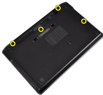
4. Heben Sie die Abdeckung an und entfernen Sie sie vom Computer.
