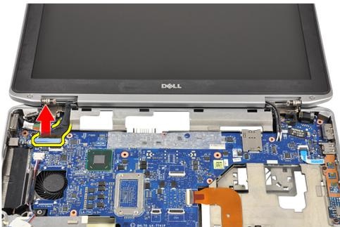
9. Ziehen Sie die Antennenkabel aus der Öffnung auf der Systemplatine.
