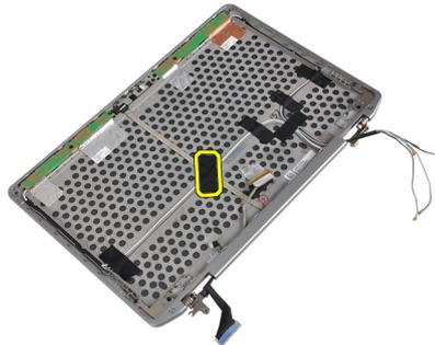
4. Trennen Sie das Kamerakabel von Kamera- und Mikrofonmodul.
