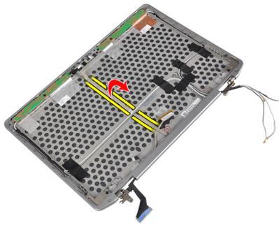
6. Entfernen Sie das LVDS- und Kamerakabel von der Abdeckung der Bildschirmbaugruppe.
