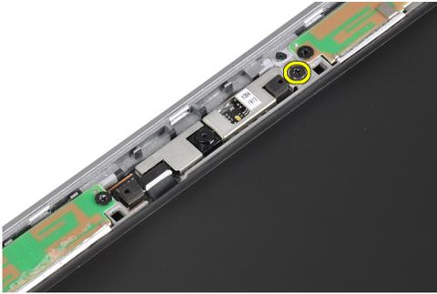
4. Trennen Sie das Kabel des Kamera- und Mikrofonmoduls vom Modul.
