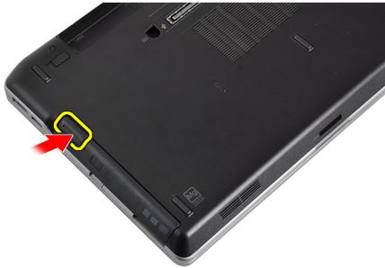
4. Ziehen Sie das Festplattenlaufwerk aus dem Computer heraus und entfernen Sie es.
