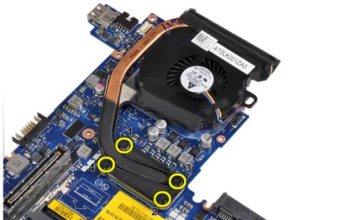
5. Entfernen Sie den Kühlkörper von der Systemplatine,
