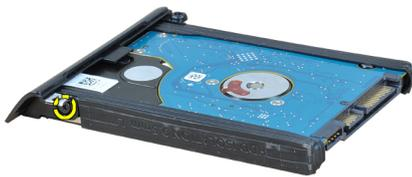
6. Ziehen Sie die Festplatte aus der Festplattenlaufwerkhalterung.
