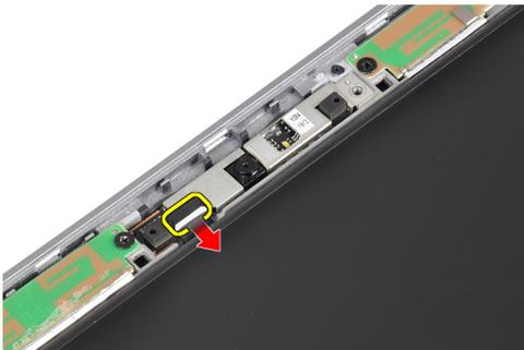
5. Entfernen Sie das Kamera- und Mikrofonmodul von der Bildschirmbaugruppe.
