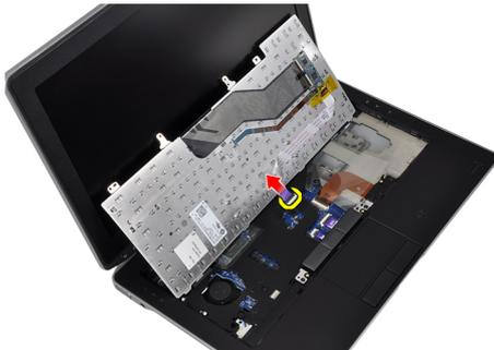
8. Entfernen Sie die Tastatur aus dem Computer.
