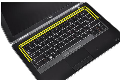
5. So entfernen Sie das Tastaturgehäuse von der Einheit.
