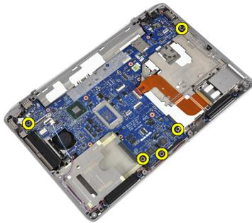
7. Heben Sie die Systemplatine an der linken Kante so weit an, bis sie sich in einem 45-Grad-Winkel befindet.
