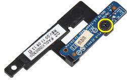
7. Entfernen Sie die LED-Platine vom LED-Platinen-Träger.
