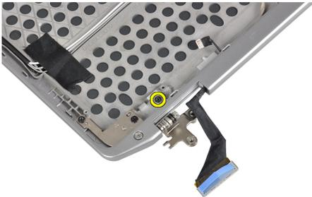
4. Schieben und entfernen Sie die linke Bildschirmscharnierplatte aus der Bildschirmbaugruppe.
