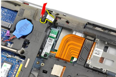
5. Entfernen Sie das Bluetooth-Kabel aus seiner Kabelführung.
