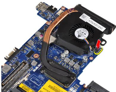
4. Entfernen Sie die Schrauben, mit denen der Kühlkörper an der Systemplatine befestigt ist.
