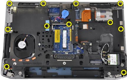
4. Entfernen Sie die Schrauben, mit denen die Handballenstützen-Baugruppe an der Vorderseite des Computers befestigt ist.
