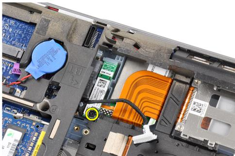
7. Entfernen Sie das Bluetooth-Modul aus dem Computer.
