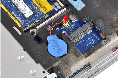
4. Entfernen Sie die Knopfzellenbatterie aus dem Computer.
