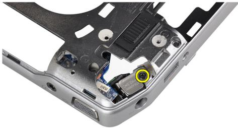
4. Entfernen Sie die Stromversorgungshalterung vom Computer.
