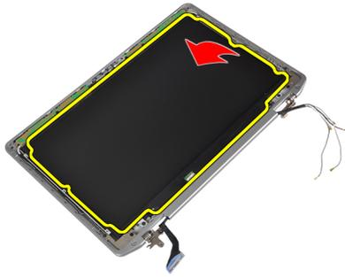
6. Lösen Sie Klebeband vom LVDS-Kabel und trennen Sie das LVDS-Kabel vom Bildschirm.
