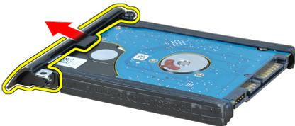
7. Entfernen Sie die Abstandshalter vom Festplattenlaufwerk.
