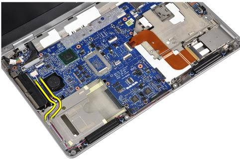
5. Entfernen Sie die Schrauben, mit denen die Lautsprecher am Computer befestigt sind.
