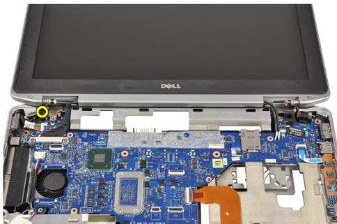
6. Entfernen Sie die Schrauben, mit denen der LVDS-Haltebügel befestigt ist.
