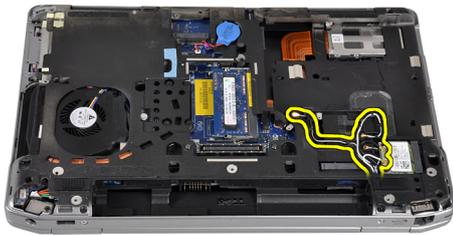
4. Entfernen Sie die Schrauben, mit denen die Bildschirmbaugruppe am Computer befestigt ist.
