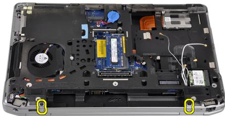
5. Entfernen Sie die Schraube, mit der das linke Bildschirmscharnier am Computer befestigt ist.
