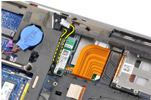
6. Entfernen Sie die Schraube, mit der das Bluetooth-Modul am Computer befestigt ist.
