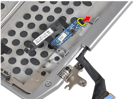
6. Entfernen Sie die Schraube, mit der die LED-Platine am LED-Platinen-Träger befestigt ist.
