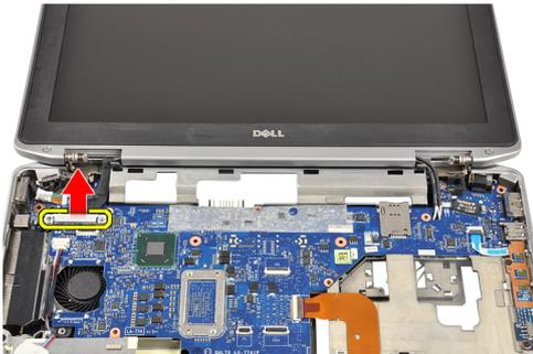
8. Trennen Sie das LVDS-Kabel von der Systemplatine.
