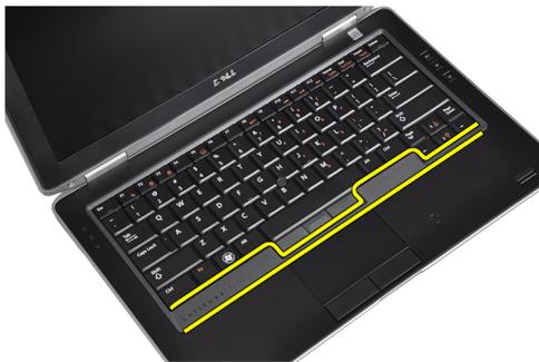
4. Hebeln Sie den Tastaturrahmen entlang der Seiten und entlang der Unterkante nach oben.
