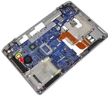
6. Entfernen Sie die Schrauben, mit denen die Systemplatine am Computer befestigt ist.
