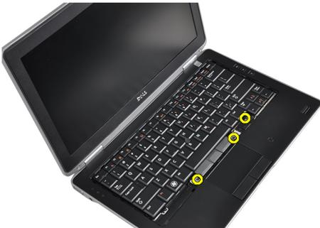
6. Heben Sie die Tastatur an und drehen Sie diese, sodass Sie das Tastaturkabel erreichen können.
