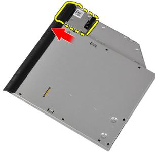
7. Ziehen Sie die Schrauben fest, mit denen die Halterung der Laufwerksverriegelung am optischen Laufwerk befestigt ist.
